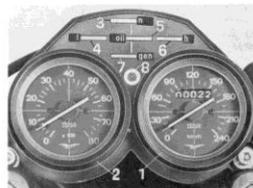
5 Spia controllo pressione olio (rossa). Si spegne quando la pressione è sufficiente ad assicurare la lubrificazione del motore. Se la spia non si spegne, la pressione non è quella prescritta; in tal caso si deve arrestare immediatamente il motore ed effettuare le opportune verifiche.
