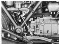
■ levare la copiglia, sfilare la spina, allentare il controdado «B» e avvitare o svitare il forcello «C», fino a trovare la posizione ideale del pedale di comando «F», rimontare la spina tenuta tirante e la copiglia.
